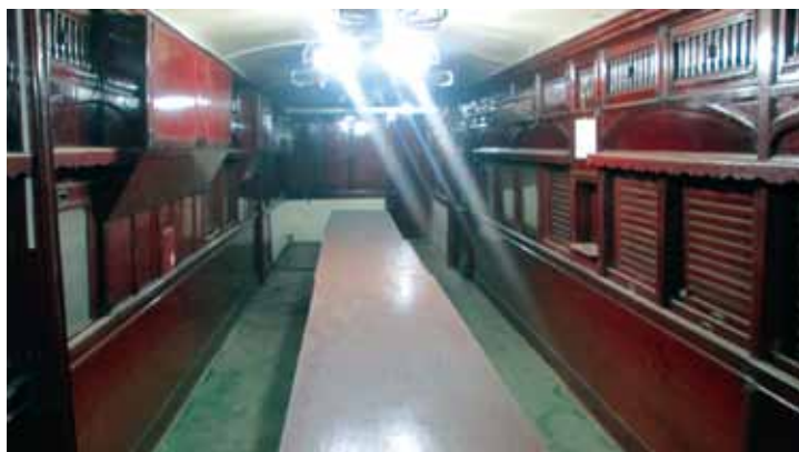
চিত্র ৪৩ : ১৯২২ সালে স্কটল্যান্ড- এ প্রস্তুতকৃত স্টীল আভারফ্রেমের উপর কাঠের তৈরি সেলুন
